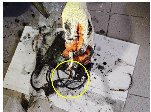
鐵捲門電源線發現有短路熔痕
