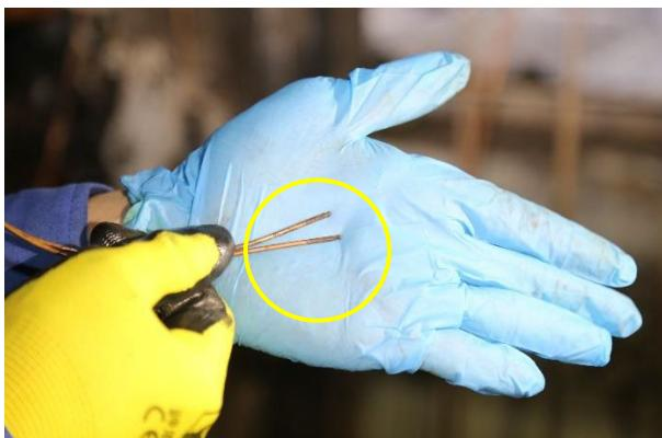
室內電源線短路有熔痕情形
