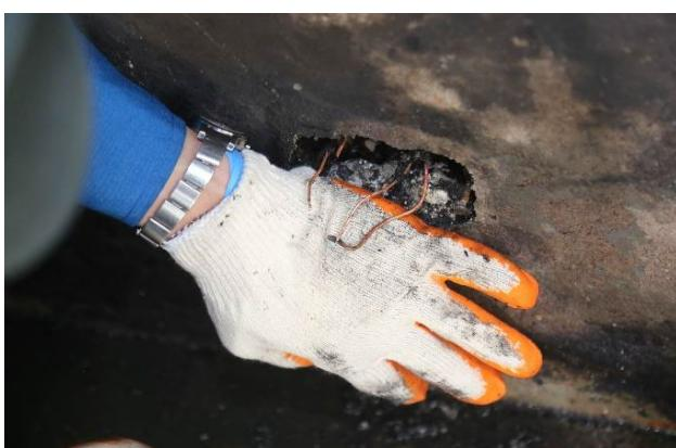
插座電源線短路有熔痕情形
