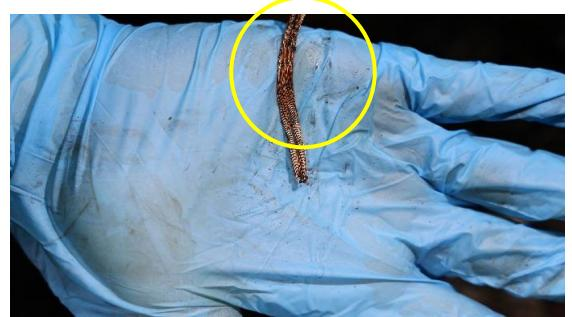
延長線電源線有熔痕情形
