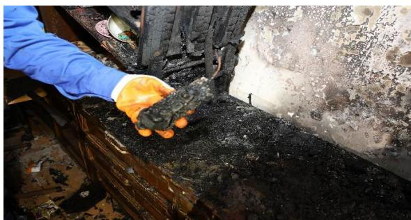
清理起火處發現延長線燒熔情形
