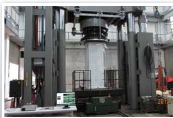
實尺寸短柱力學實驗
